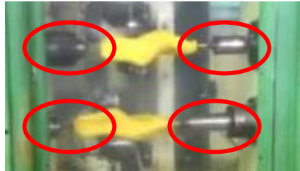
Gambar 3.4. Pencekaman / penjepitan benda kerja
