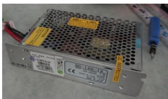
Gambar 3.6. Bentuk Fisik *Switch Mode Power Supply*
