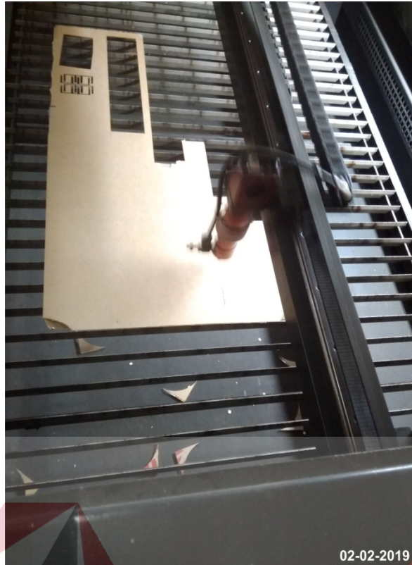
Gambar 4.40 Proses Pemotongan Acrylic Menggunakan Mesin Cutting (Sumber : Dokumen pribadi)
