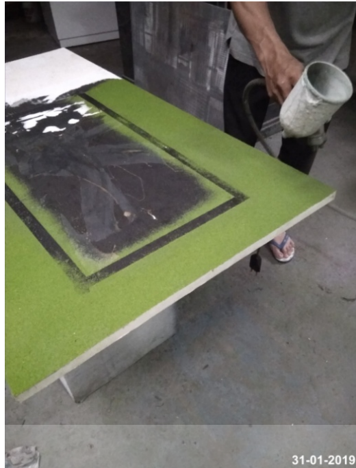
Gambar 4.23 Proses Penempelan Crumb
