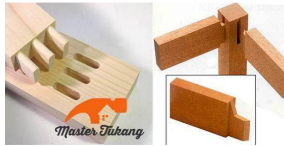
Gambar 2. 3 Sambungan Kayu kayu Purus Lubang
