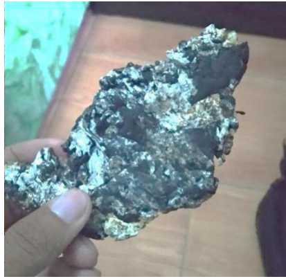
Gambar 4. 7 Hasil bakaran plastik yang buruk
