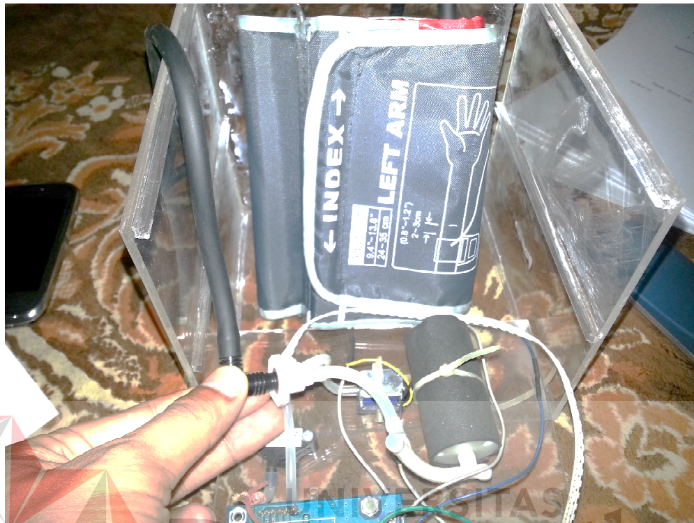
Gambar 3.13. Rangkaian alat pengukur tekanan darah
