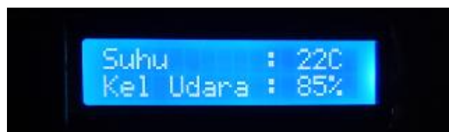
Gambar 4.3 Hasil Pengujian I2C LCD 16x2 (Sumber: Olahan Penulis)
