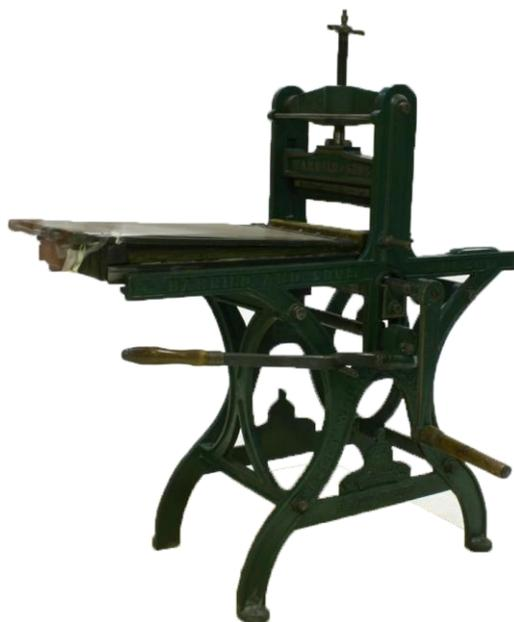
Gambar 3.1 mesin cetak menggunakan metode awal proses cetak (*Lithographic hand press*).
