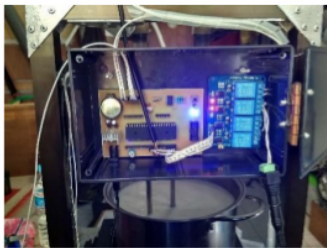
Gambar 4. Rangkaian perangkat keras sistem pengendali pasteurisasi susu
