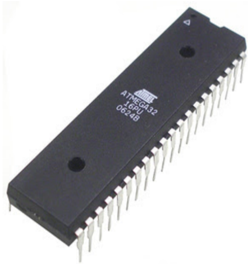
Gambar 2.8 Bentuk Fisik Mikrokontroler AVR ATMEGA32 PDIP 40 Pin
