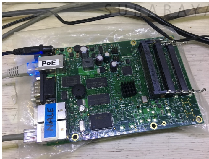
Gambar 3.6 RB433 yang digunakan sebagai web proxy
