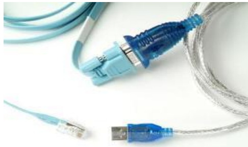
Gambar 4.10 Kabel Rollover dan Kabel Serial to USB yang Saling Terhubung
