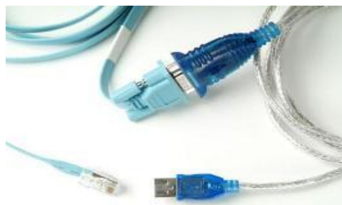
Gambar 4.9 Kabel Rollover dan Kabel Serial to USB yang Saling Terhubung
