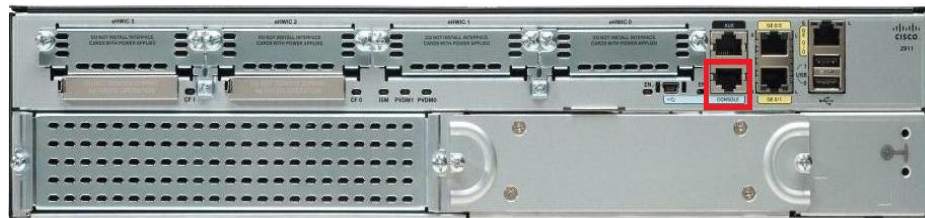
Gambar 4.10 Port Console pada Router
