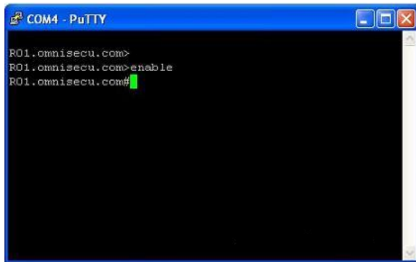
Gambar 4.12 CLI pada Router Menggunakan Putty
