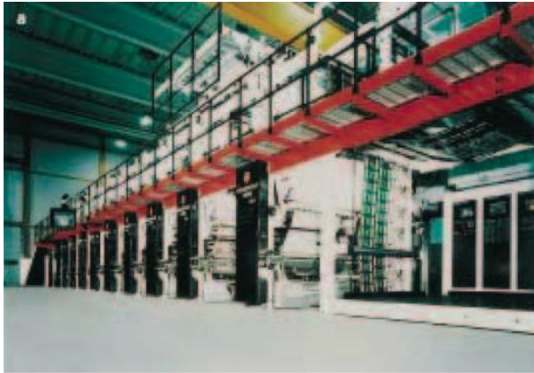
Gambar 3.20. Mesin Rotogravure dengan 10 unit cetak
