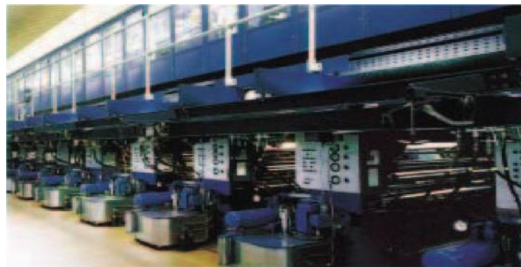
Gambar 3.19. Mesin Cetak Rotogravure dengan cadangan tinta pada tangki penyuplai di bagian depan
