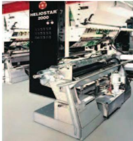
Gambar 3.13. Rotogravure yang dilengkapi peralatan bantu untuk penggantian lapisan silinder gravure dan unit penintaan untuk mempercepat proses pengangantiannya.
