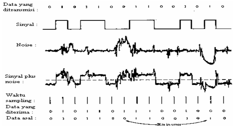
Gambar 3.7. Sinyal Proses Transmisi Data Disertai Dengan Noise.
