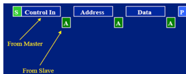
Gambar 2.27 Proses Menulis Pada Serial EEPROM
