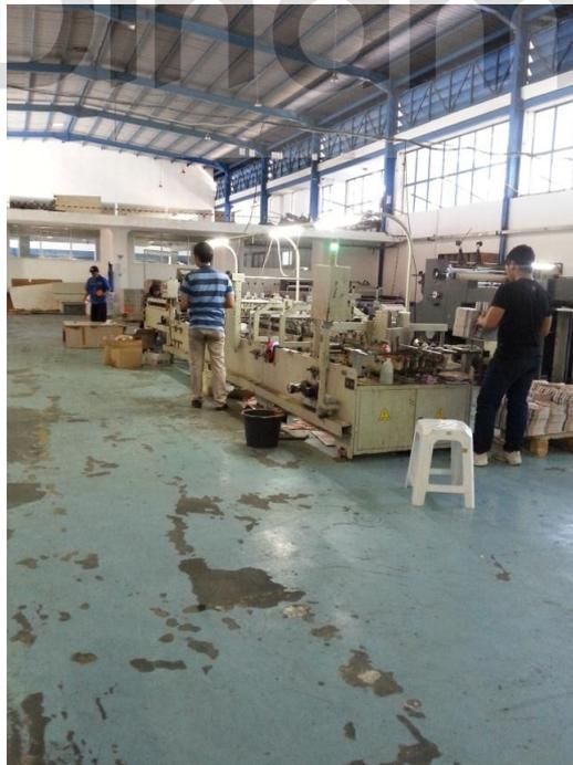
Gambar 3. 6 Mesin Lipat dan Glueing
