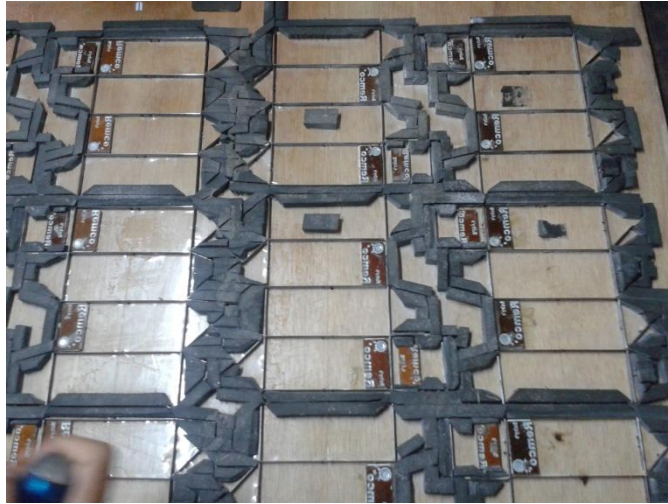
Gambar 2. 5 : Pisau Stand dan Ram pada meja acuan (Sumber : PT TEMPRINA MEDIA GRAFIKA)
