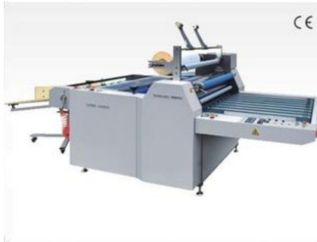
Gambar 2. 4 : Mesin Laminating Dingin
