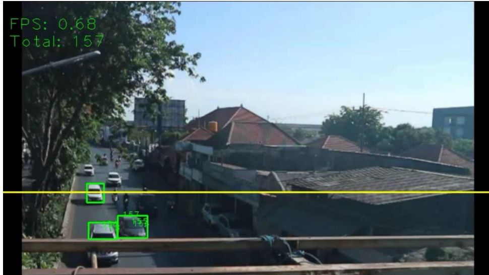
Gambar 3. 2 Garis Pendeteksi Kendaraan yang Lewat
