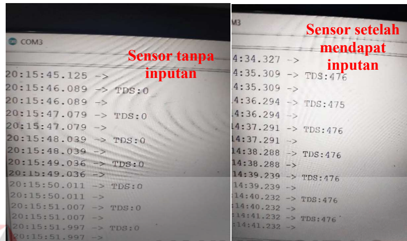
Gambar 4.7 Sensor Yang Belum dan Sudah Mendapatkan Inputan
