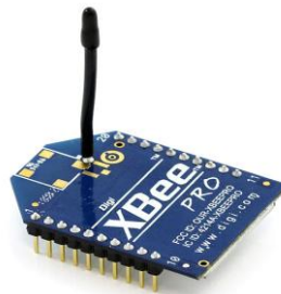
Sumber : Manual Xbee-Pro, 2011 Gambar 2.9. Modul X-Bee Pro
