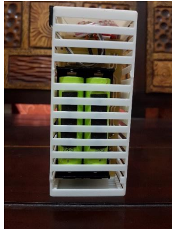
Gambar 4. 10 Tampak Belakang Rangkaian Baterai
