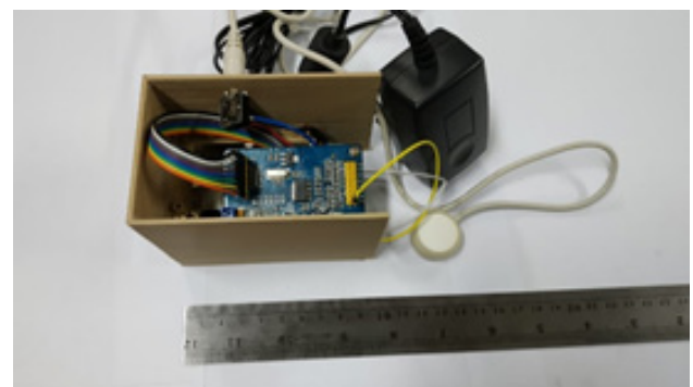
Gambar 2. Modul sebuah node sensor untuk pengambilan sinyal PCG
