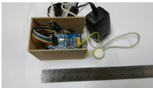
Gambar 2. Modul sebuah node sensor untuk pengambilan sinyal PCG
