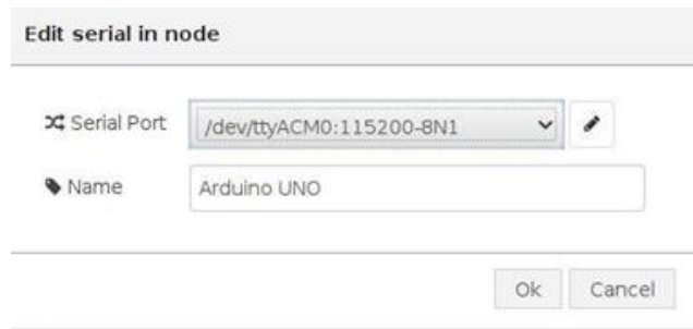
Gambar 2.14 Konfigurasi penerimaan data ke Raspberry Pi 2
