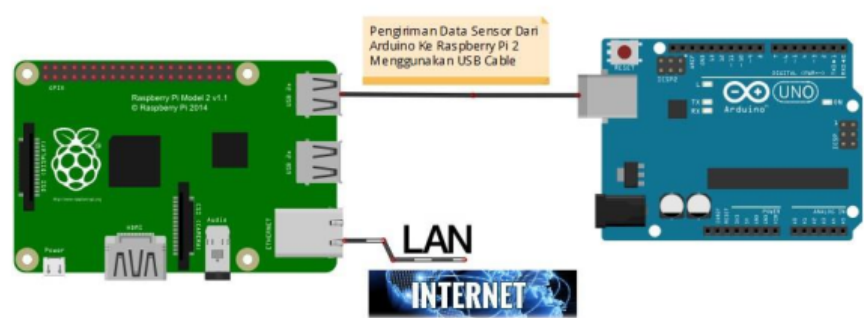
Gambar 2.6 Hubungan Arduino dengan Raspberry Pi 2.
