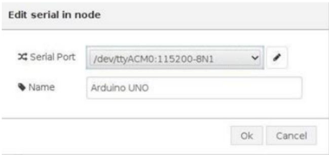
Gambar 2.14 Konfigurasi penerimaan data ke Raspberry Pi 2
