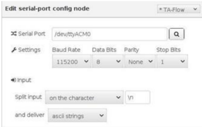
Gambar 2.15 Lanjutan konfigurasi serial port di NODE-RED
