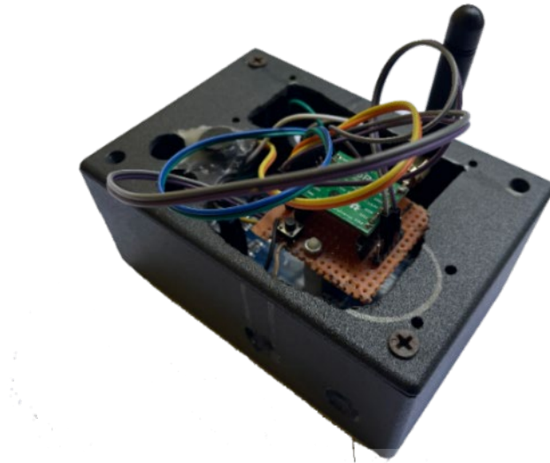
Gambar 3.5 Hasil Rangkaian Node Receiver dengan Black Box
