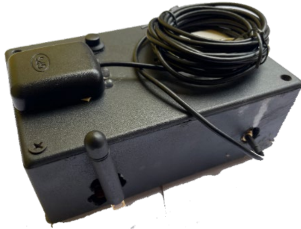
Gambar 3.3 Hasil Rangkaian Node Transmitter dengan Black Box
