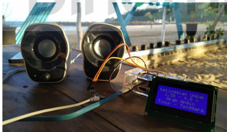
Gambar 3.15 Model perancangan saat diambil data di kampung nelayan pancer
