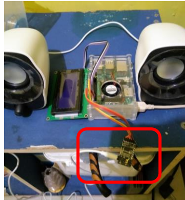
Gambar 3.7 Tampak koneksi Raspberry Pi dengan PCM5102 dan Speaker
