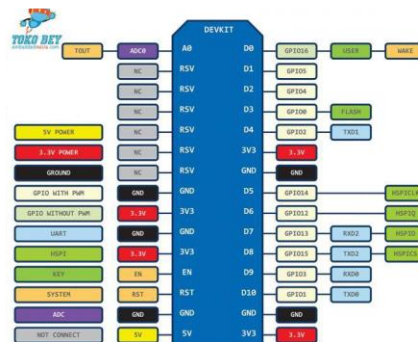
Gambar 2.4 Skematik posisi pin NodeMCU devkit v1 (Sumber: embeddednesia.com)
