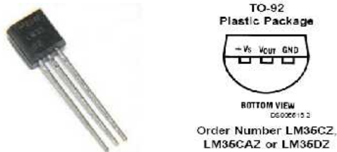
Gambar 2.14. konfigurasi Pin LM35 dan IC LM35
