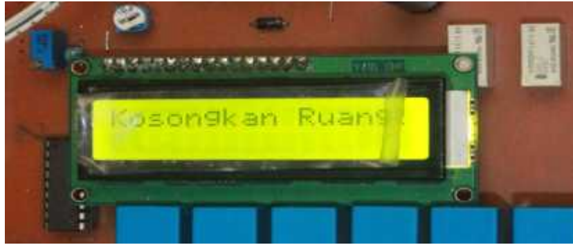
Gambar 4.6 Tampilan LCD saat Proses mengkosongkan ruang pemanas.
