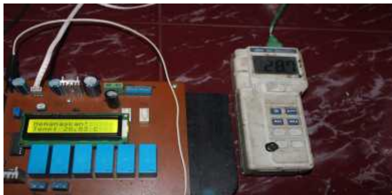
Gambar 4.14. Percobaan pada Malam Hari dengan Thermometer .
