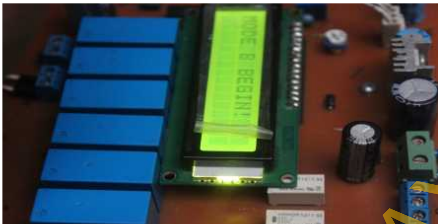
Gambar 4.11. Tampilan LCD setelah Push Button “Mode B” ditekan
