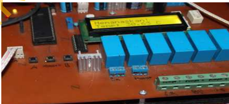
Gambar 4.16 Heater Dalam Kondisi Aktif.
