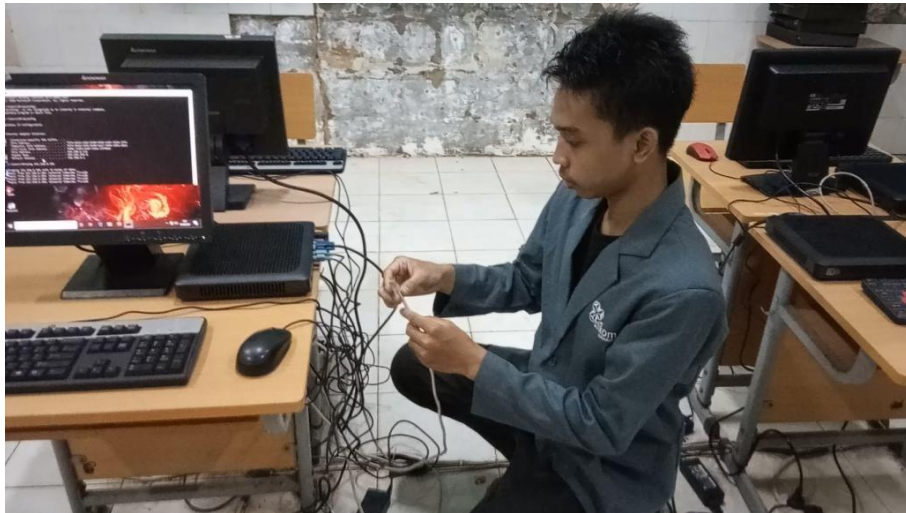
Gambar 3.15 Pemasangan Kabel LAN pada PC Client
