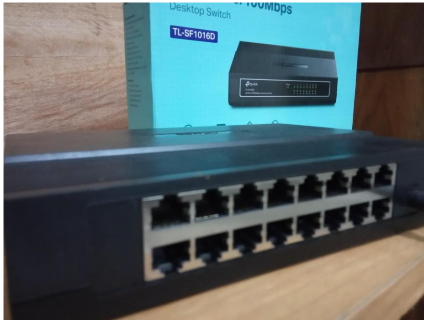
Gambar 3.16 Switch Tp-link TL-SF1016D
