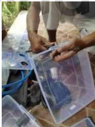
Gambar 4.21 Proses Pemasangan Konektor slang
