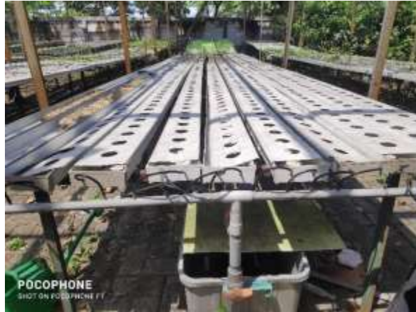
Gambar 2.7 Rak Hidroponik Sederhana dengan Bahan Paralon
