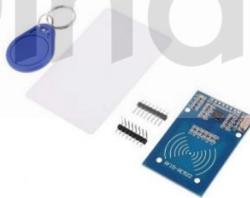
Gambar 2. 7 Bentuk fisik MFRC522 dan RFID Tag (Sumber: Mahali, 2016)
