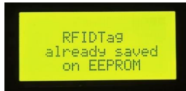
Gambar 4. 15 RFID Tag telah terdaftar di EEPROM
