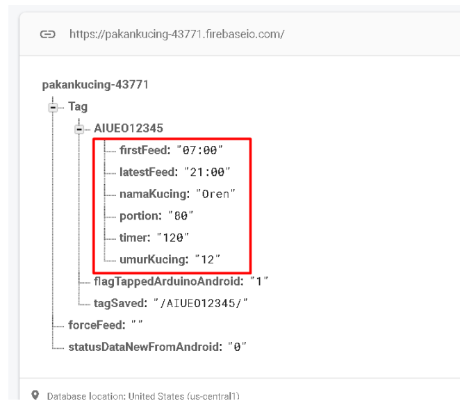
Gambar 4. 5 Pengujian update data ke Firebase
