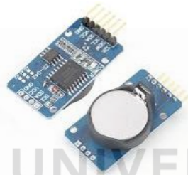
Gambar 2. 4 Bentuk fisik RTC DS3231 (Sumber: Hapsari, 2012)
