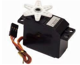
Gambar 2. 10 Bentuk fisik motor servo (Sumber: Owen, 2004)
