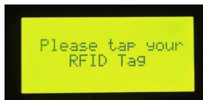
Gambar 4. 14 Display LCD untuk tap create Tag baru
