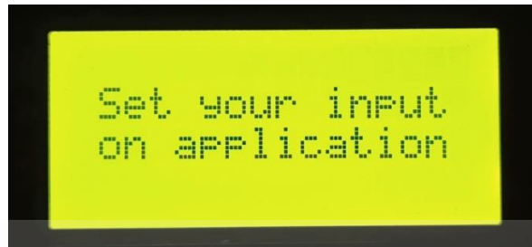
Gambar 4. 16 Display LCD jika RFID Tag belum terdaftar
