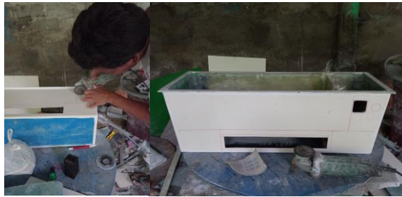
Gambar 4.15 Membuat Lubang Komponen dan Kaca
