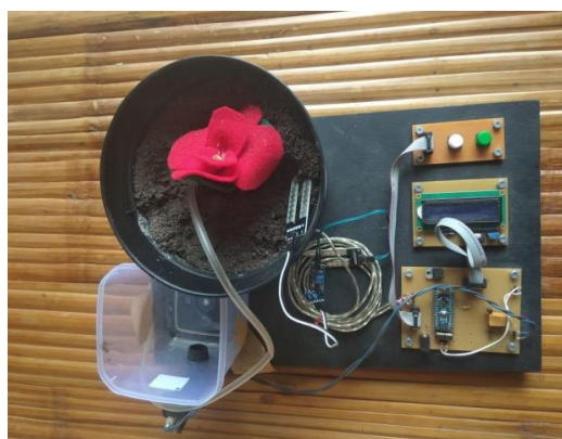
Gambar 2.3 Pot Penyiram Otomatis dengan Sensor Soil Moisture Sensor
