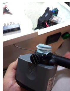
Gambar 4.20 Memasang Filter Air pada Pompa Air
