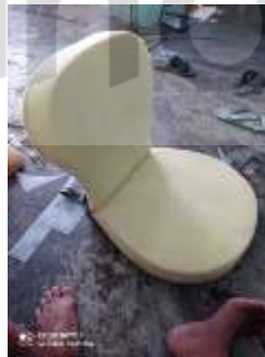
Gambar 4.10 Proses Pemasangan Spon Pada Dudukan dan Sandaran
