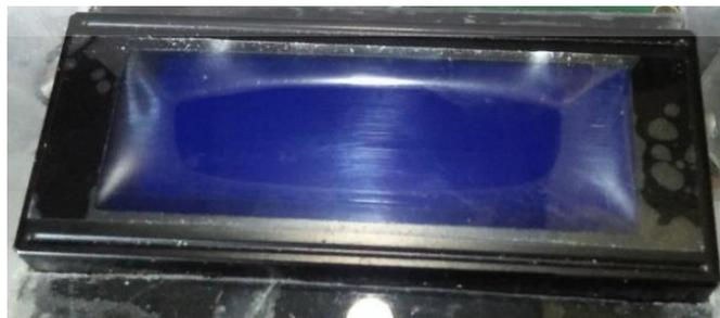
Gambar 2.4 LCD 20x4 dan I2C
