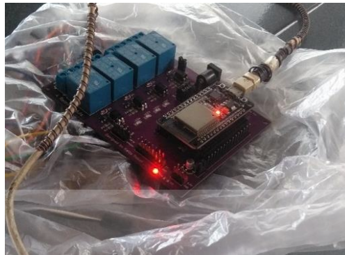
Gambar 4. 3 Relay dalam kondisi OFF
