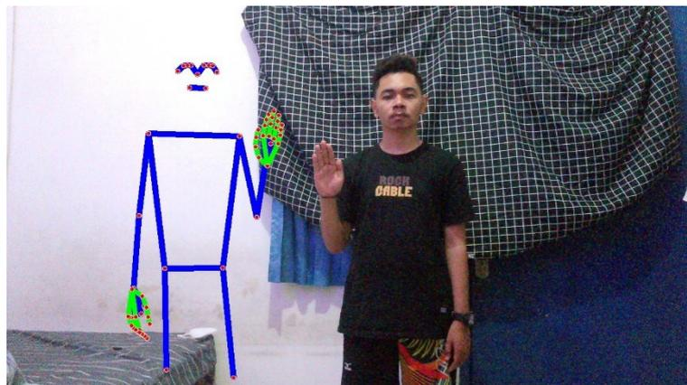
Gambar 3.4 Contoh dataset yang telah di proses *horizontal flip* dan *random move*
