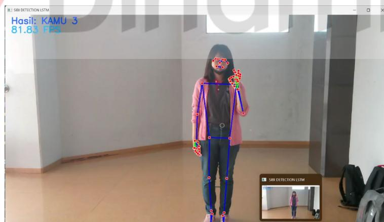
Gambar 4.4 Pengujian sistem dengan jarak 3 meter dan hasil prediksi benar
