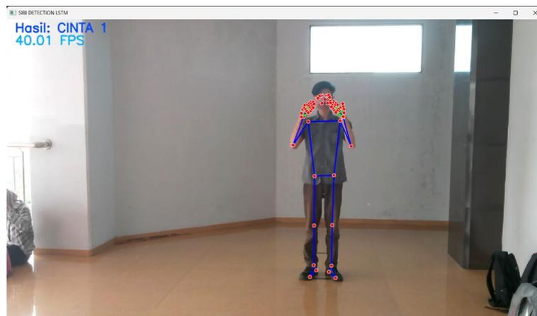
Gambar 4.5 Pengujian sistem dengan jarak 4 meter dan hasil prediksi salah
