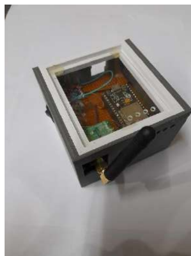
Gambar 3.3 Tampak depan end node
