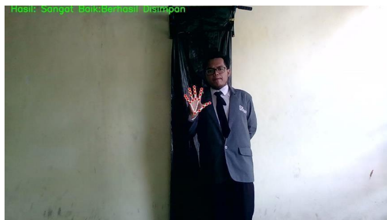
Gambar 4.18 Hasil gambar pengujian Mediapipe Hand Landmark dengan jarak 200cm dan simbol sangat baik
