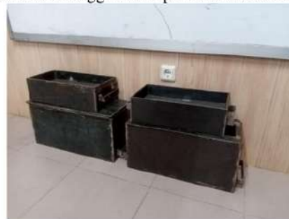
Gambar 4: Cetakan paving block
