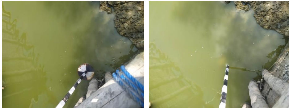
Gambar 3.6 Pengukuran Kekeruhan Menggunakan Tongkat Milik Tambak Udang
