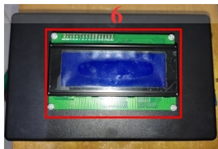
Gambar 3. 7 Bagian Luar Kotak Mikrokontroler
