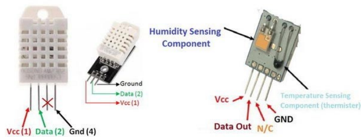
Gambar 2. 7 Sensor DHT22 (Sumber: arduitech, 2023)
