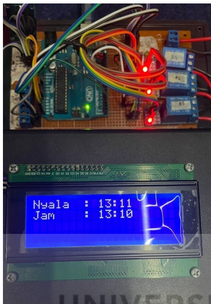
Gambar 4. 7 Kondisi Solenoid dan Kipas DC Mati
