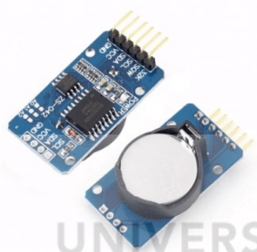
Gambar 2. 8 Sensor RTC DS3231 (Sumber: Sitepu, 2023)
