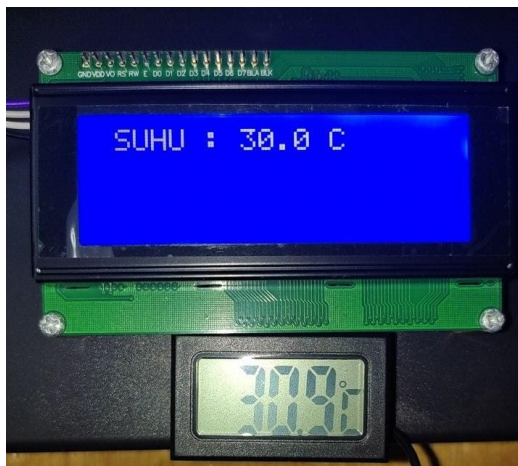
Gambar 4. 4 Data Sensor DHT22 dan Thermometer Digital Ruangn Biasa
