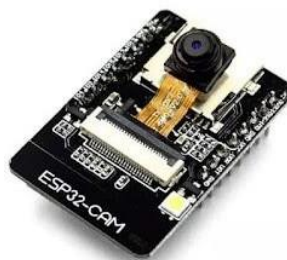
Gambar 2. 3 ESP32-CAM (Sumber : Kurniawan, 2022)
