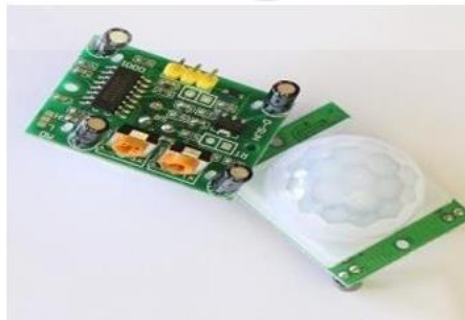
Gambar 2. 6 Sensor PIR (Sumber : Monita & Hendri, 2021)
