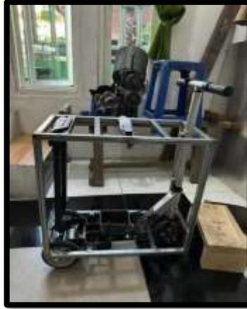
Gambar 4.8 Proses Pemasangan Kerangka Koper
