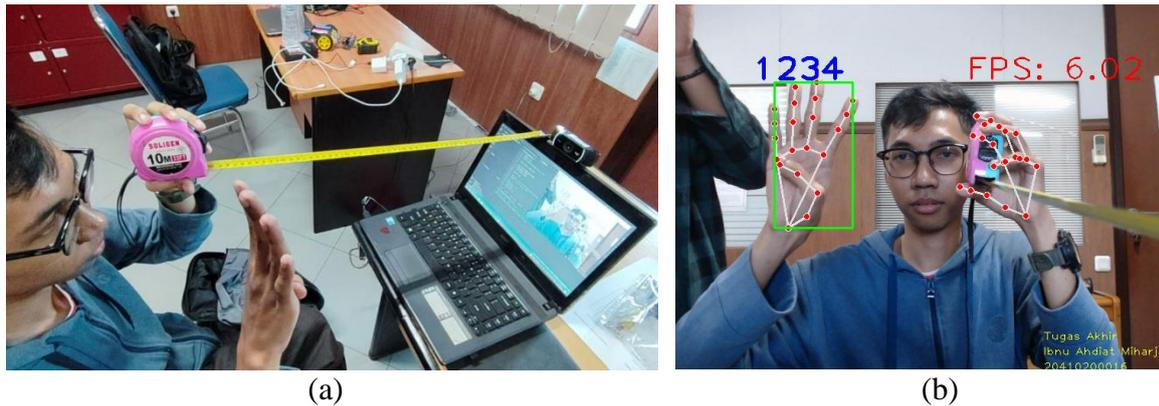
Gambar 4.5. (a) Proses deteksi pada jarak 60 cm, (b) Hasil deteksi *gesture* jari tangan deret keempat
