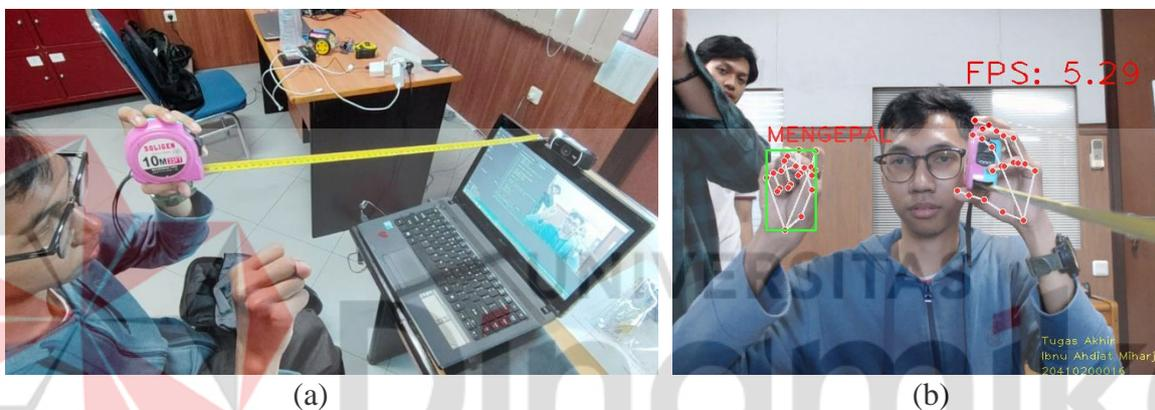
Gambar 4.6. (a) Proses deteksi pada jarak 60 cm, (b) Hasil deteksi *gesture* jari tangan deret mengepal
