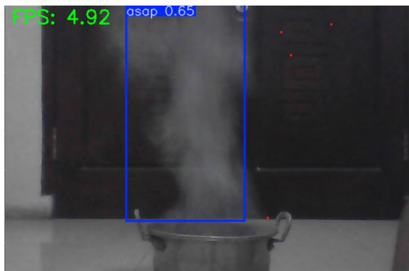
Gambar 4.1 Metode pengujian panci yang dibiarkan terbuka
