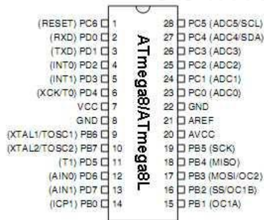
Gambar 3.1. IC microcontroller ATmega8 (ATMEL,2011)
